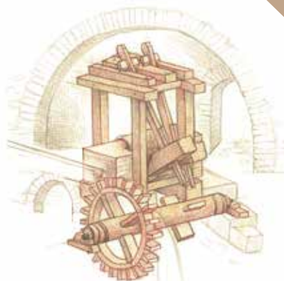
Esquema de batán construido por jerónimos
